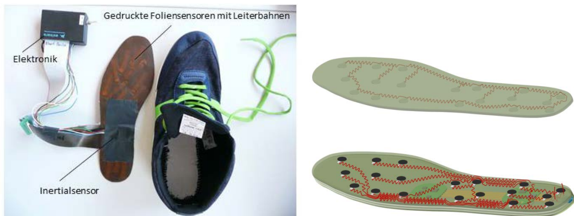
Abbildung 2.1: Schuheinlage mit gedruckten Folien-Kraftsensoren, Inertialsensor und Elektronik (links); Sensorverteilung und Leiterbahnen (rechts)
