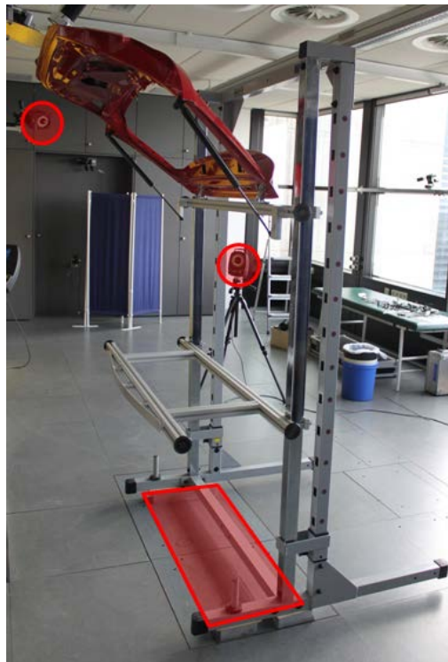
Abbildung 2.1: Messaufbau einer Heckklappe mit Kraftmessplatte und Kameras (rote Bereiche)
