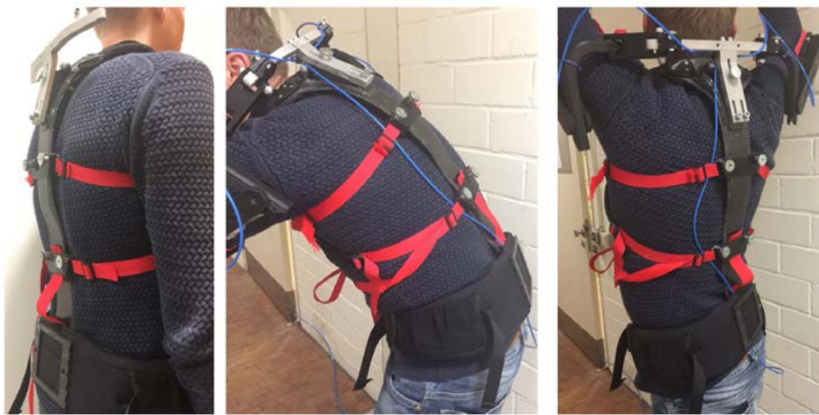
Abbildung 5.4: Der Körperform angepasste flexible Rückenkonstruktion erlaubt Beugen und Rotation um Körperlängsachse
