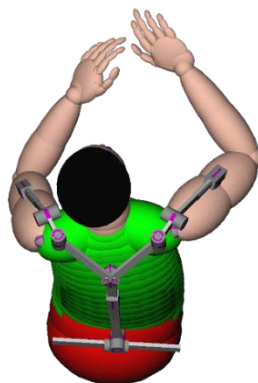
Abbildung 3.3: Nachbau des orthetisch unterstützenden Systems zur Simulation und Optimierung (alaska/Dynamicus) des Rückstellmomentes zur Entlastung des Schultergelenkes
