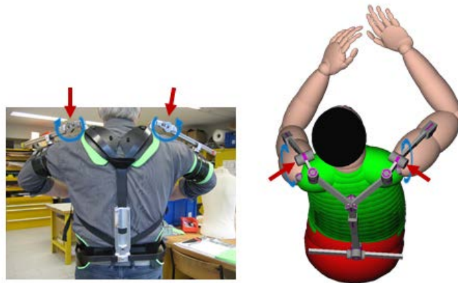
Abbildung 2.3: Digitaler Nachbau des Unterstützungssystems von der Otto Bock HealthCare GmbH (rechts). Die Gelenke oberhalb der Schultergelenke wurden zur Unterstützung des Armes mit verschiedenen Rückstelldrehmomenten (1-40 Nm) versehen (roter Pfeil).
