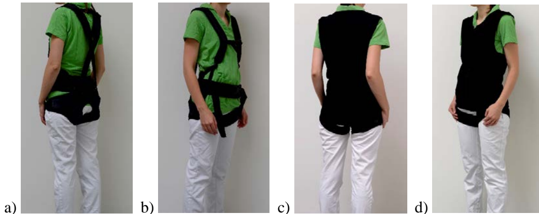
Abbildung 2.1: Smart Suit als Trägervariante (a und b) und in eine Weste integriert (c und d). Beide Varianten können über der Pflegekleidung getragen werden und besitzen gekreuzte flexible Bänder im Rückenbereich, die beim Vorbeugen des Oberkörpers gespannt werden.
