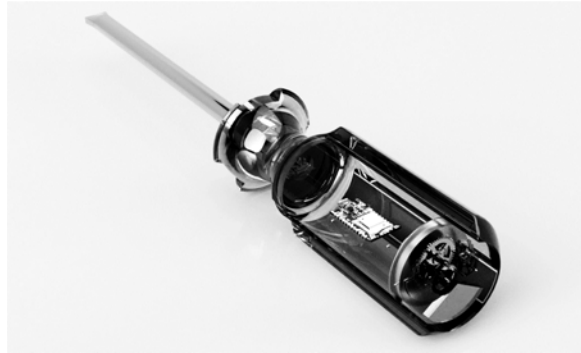
Abbildung 3.3: 3D-Entwurf des Harvesting- und Übertragungssystems im Schraubendrehergriff
