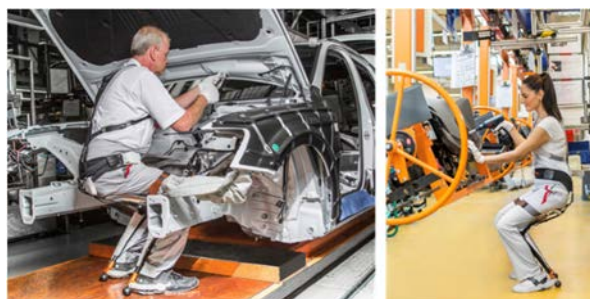
Abbildung 4: Pilotarbeitsplätze (links: Verkabelung Motorraum, rechts: Cockpitvormontage)
