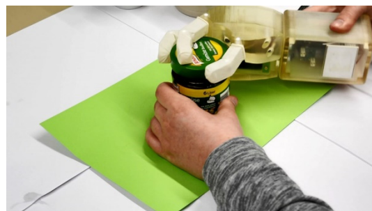
Abbildung 11: Beispiel des adaptiven Greifens
