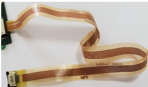
Abbildung 5: Elastische Leiterplatte (TWINflex Stretch)
